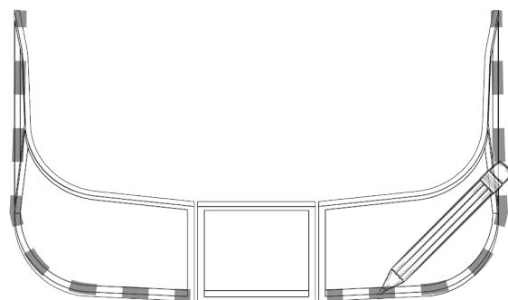
Очерчиваем контур рамки карандашом для наклеивания уплотнителя (под рамку) с клеевой основой.
