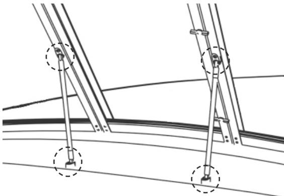
Устанавливаем упорные стойки «враспор» обеспечивая оптимальную геометрию створа калитки.
