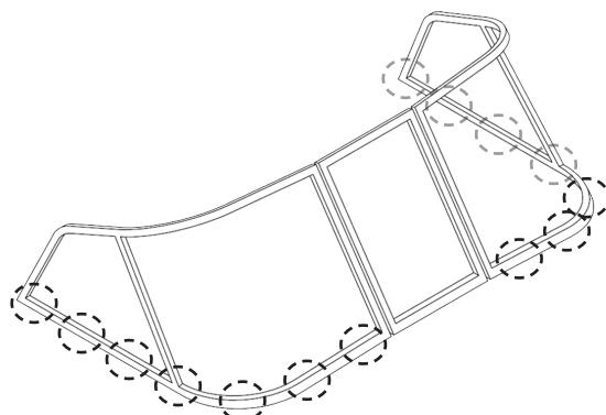
Устанавливаем рамку на место и фиксируем ее на лодке винтами через подготовленные ранее отверстия.
