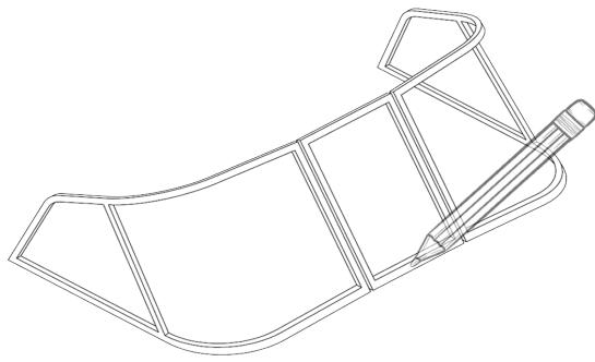
Для дальнейшего, точного, позиционирования ветрового стекла относительно оси симметрии лодки. Так же необходимо отметить центр палубы в районе выхода (калитки).
