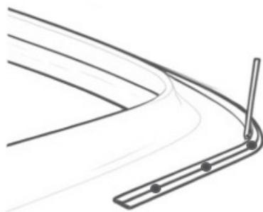
С помощью пробойника (шило, отвертка), в местах крепления рамки, делаем отверстия в уплотнителе, чтобы предотвратить налипание на винты kleевой основы.
