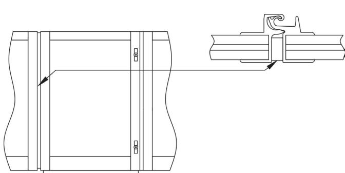
Наклеиваем уплотнитель 6х12 в проём калитки.
