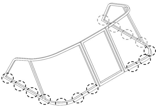
В нижнем профиле рамки есть отверстия, через которые будет осуществляться крепление ветрового стекла к корпусу лодки. В случае если по какой-то причине вы не можете использовать данные отверстия, необходимо самостоятельно просверлить профиль рамки в ближайшем доступном месте используя для этого сверло диаметром 4,8-5 мм.
