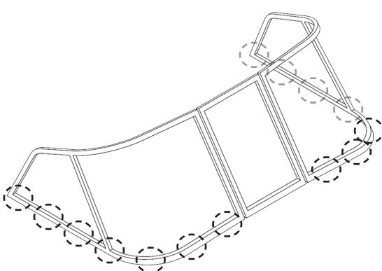
Затем в отмеченных ранее точках, с помощью сверла 4,8 мм в палубе лодки просверливаем отверстия и фиксируем рамку к корпусу лодки винтами M4x40
