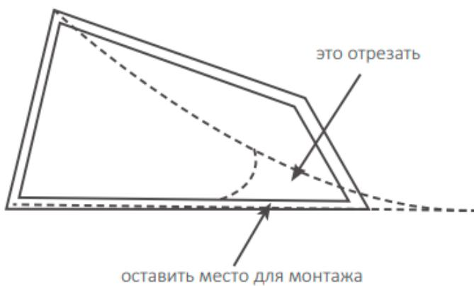
После того как рамка установлена по контрольным точкам, прижать ветровое стекло к лодке и отметить линию реза для удаления частей старого корпуса учитывая геометрию устанавливаемого изделия
